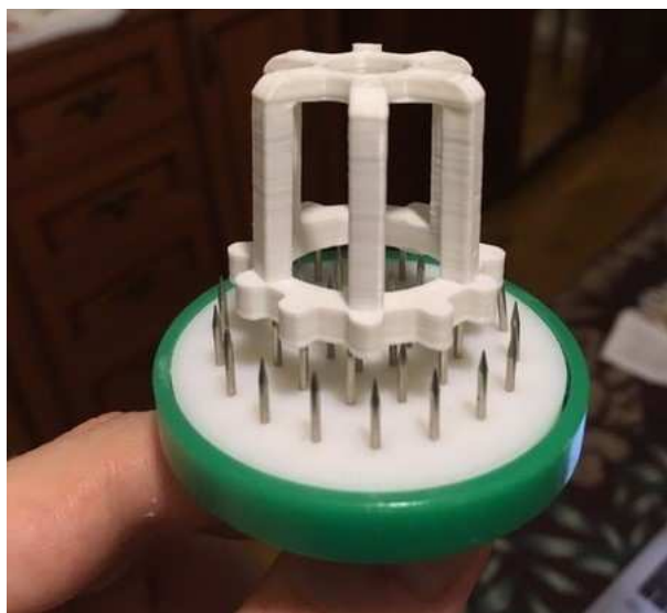
Рис. 7 Защитный колпачок из PLA-пластика
