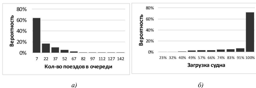
Рис. 8 Гистограммы распределения вероятностей: а – количества поездов в очереди; б – загрузки судов
