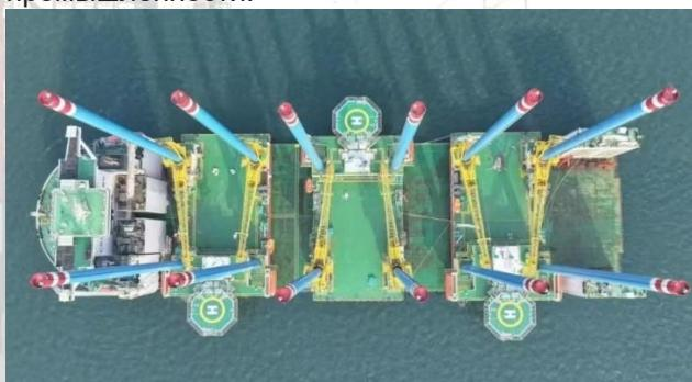
**Компания Huisman поставит третий грузовой кран для морского судна с ветряными турбинами, построенного компанией Hanwha.** Hanwha Ocean заказала у компании Huisman третий опоясывающий опору кран (LEC) грузоподъемностью 2 600 тонн для судна для установки ветряных турбин на платформе NG-16000X. Кран отличается малым весом, высокой точностью позиционирования и энергоэффективностью. Его конструкция позволяет оптимизировать пространство на палубе. Кран будет соответствовать требованиям
