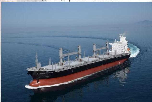
**Завершение строительства сухогрузов RODOPI грузоподъемностью 64 000 тонн.** Судно типа «хэнди-макс» способно перевозить насыпные грузы, зерно, руду и другие материалы, а также грузы по кодексам МСУГ и МПОГ. Оно оснащено широкими люками и четырьмя палубными кранами для
