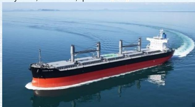
**Завершено строительство балкера CLIPPER MALLORCA дедвейтом 40 000 т.** Это океанское судно с двойным корпусом, оснащенное четырьмя палубными кранами для обработки различных насыпных грузов. Судно соответствует экологическим требованиям, включая стандарт EEDI Phase 3 по выбросам CO<sub>2</sub>, и оснащено системой очистки балластных вод. Основные характеристики: длина 182,93 м, главный двигатель 6G45ME-C9.7, скорость около 14 узлов, класс NK, флаг - Сингапур.
