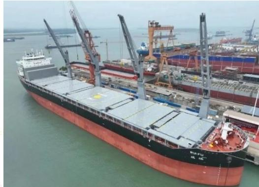
**Доставлены два многоцелевых балкера серии OCTOPUS.** Были названы и поставлены два многоцелевых судна с тяжелыми кранами типа OCTOPUS 62. Эти суда дедвейтом 62 000 тонн способны перевозить крупногабаритное оборудование (например, ветроустановки) и контейнеры. Серия OCTOPUS, разработанная Шанхайским институтом судостроения, включает широкий спектр судов дедвейтом от 3 500 до 77 000 тонн, работающих как на традиционном, так и на альтернативном топливе.
