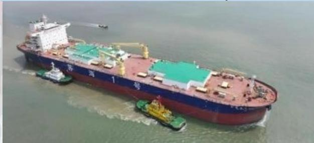
**Спущено на воду рыболовное судно Senhai Pioneer водоизмещением 80 000 тонн.** 20 июля 2025 года в Циньхуандао было спущено на воду первое в мире 80-тысячтонное рыболовное судно, созданное на базе переоборудованного балкера. Это инновационное судно с открывающимися боковыми отсеками сочетает функции разведения рыбы, переработки кормов и транспортировки. Китайское классификационное общество (CCS) сыграло ключевую роль в разработке стандартов и техническом
