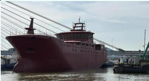
**Новый пелагический траулер для оператора из Олесунна.** В норвежский пелагический флот вошло новое судно Havfisk, построенное для компании Veibust Fiskeriselskap. Судно длиной 75,1 м и шириной 16,2 м имеет вместимость 2 530 м<sup>3</sup> в 11 танках для хранения улова. Havfisk оснащено системой автоматического траления, двумя сетевыми барабанами и мощной силовой установкой Wärtsilä. Оно предназначено для тралового промысла мерлуги и кошелькового лова скумбрии и сельди.
