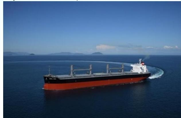
**Завершено строительство двухтопливного балкера SG DAWN дедвейтом 209 000 тонн.** Судно дедвейтом 209 000 т пред назначено для перевозки плотных грузов, таких как железная руда. При использовании СПГ оно значительно сокращает выбросы: SOx почти на 100%, CO<sub>2</sub> на 20-30%, а система SCR снижает выбросы NOx. Основные характеристики: длина 299,99 м, главный двигатель 7S60ME-C10.5-GI, скорость около 14 узлов, класс NK, флаг - Япония.
