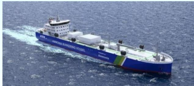
**Контракт на строительство двухтопливных аммиаковозов.** Дочерняя компания CIMC Enric, CIMC Pacific Offshore, заключила контракт на строительство двух двухтопливных аммиаковозов. Суда грузовместимостью 51 000 м<sup>3</sup> будут работать на СПГ и аммиаке, их оснастят валогенераторами и генераторными установками на аммиаке. Окончание строительства запланировано на 2028 год.
