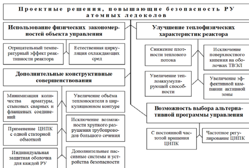
Рис. 3 Проектные решения, повышающие безопасность РУ атомных ледоколов
