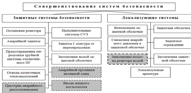
Рис. 2 Состав основных защитных и локализирующих систем безопасности
