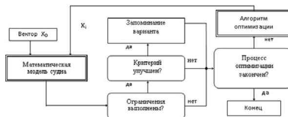
Рис. 6 Алгоритм проектирования в оптимизирующей САПР [4]
