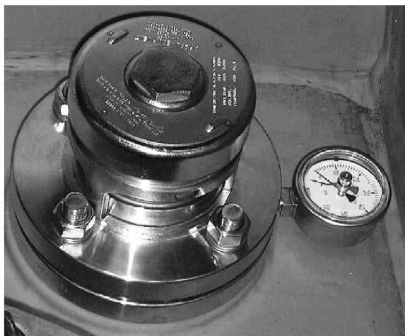
Рис. 8 Типичный предохранительный клапан с манометром
